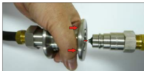
Acoplamento: Segurando apenas na capa de acionamento empurre o acoplador de encontro ao Pino "macho"
