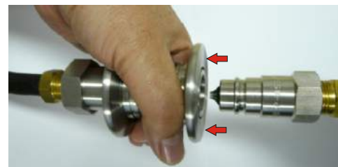
Desacoplamento: Puxe a capa de acionamento
